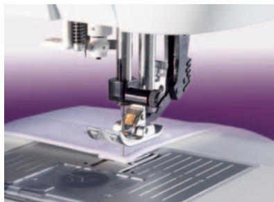
Med ett lätt tryck på fotreglaget ställer du in nålen så att den stannar uppe eller nere i tyget.
