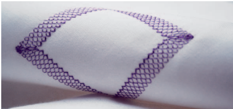
Skapa nya effekter genom att gradvis öka eller minska stygnbredden.
